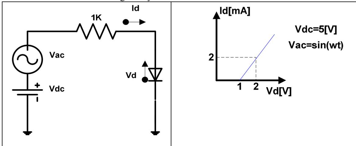
Dibuje el circuito equivalente del diodo no lineal, no diodos ideales, Fuentes y resistencias.
